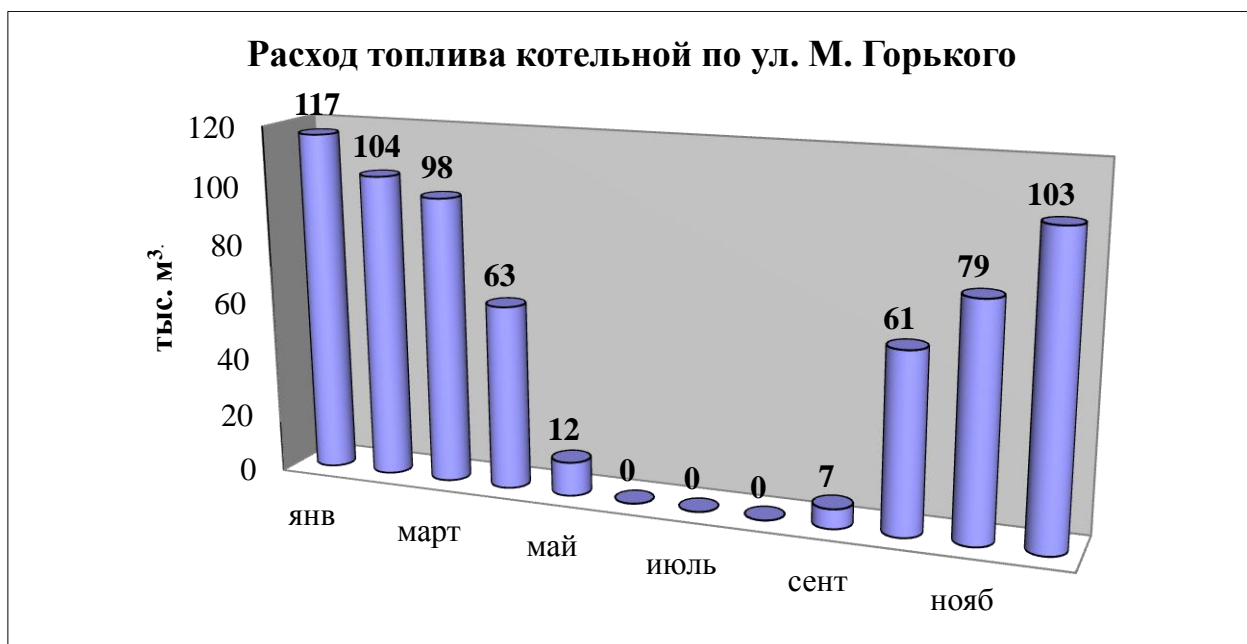
Рисунок 1.8.3 Расход топлива котельной по ул. М. Горького.
