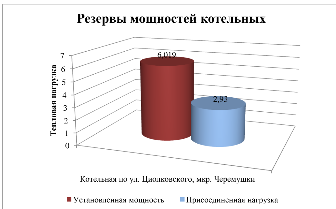
Рисунок 1.2.1.1 Резервы мощности котельной.
