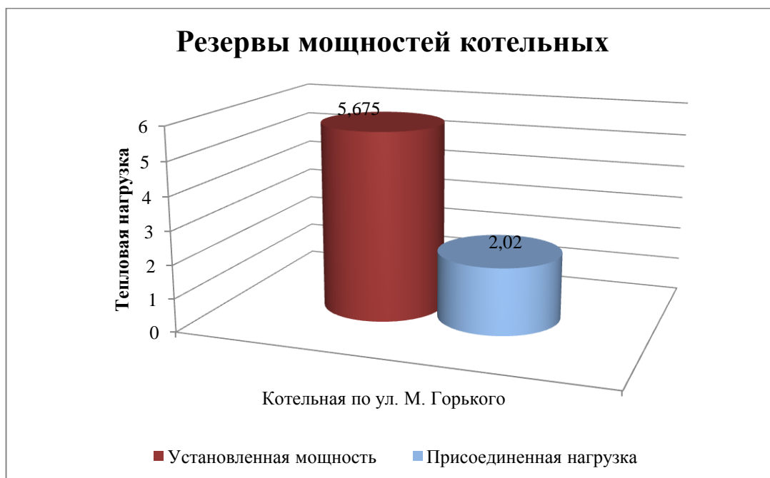
Рисунок 1.3.1.1 Резервы мощности котельной.
