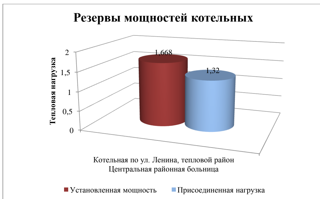
Рисунок 1.4.1.1 Резервы мощности котельной.
