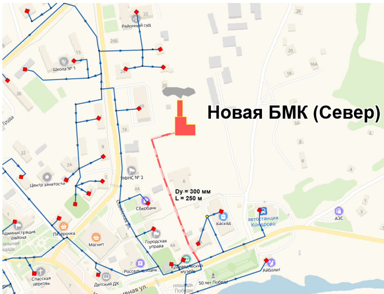
Рисунок 6.4-2 - Строительство участка тепловой сети от БМК-2 (Север)
