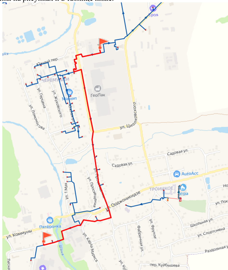
Рисунок 2 - Путь движения теплоносителя от источника тепловой энергии до конечного потребителя, в зоне действия котельной ул. Циолковского
